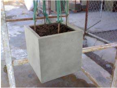
Duurzame test van de randen: Bak gevuld met aarde en water opgehangen aan haken
