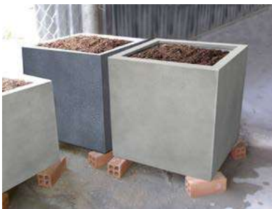
Duurzame test van wanden, bodems en hoeken: Bak gevuld met aarde en water
